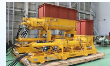
バイオガス発電で活用されている アツマイスターポンプ
